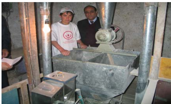
Процесс фортификации муки на малой мельнице
